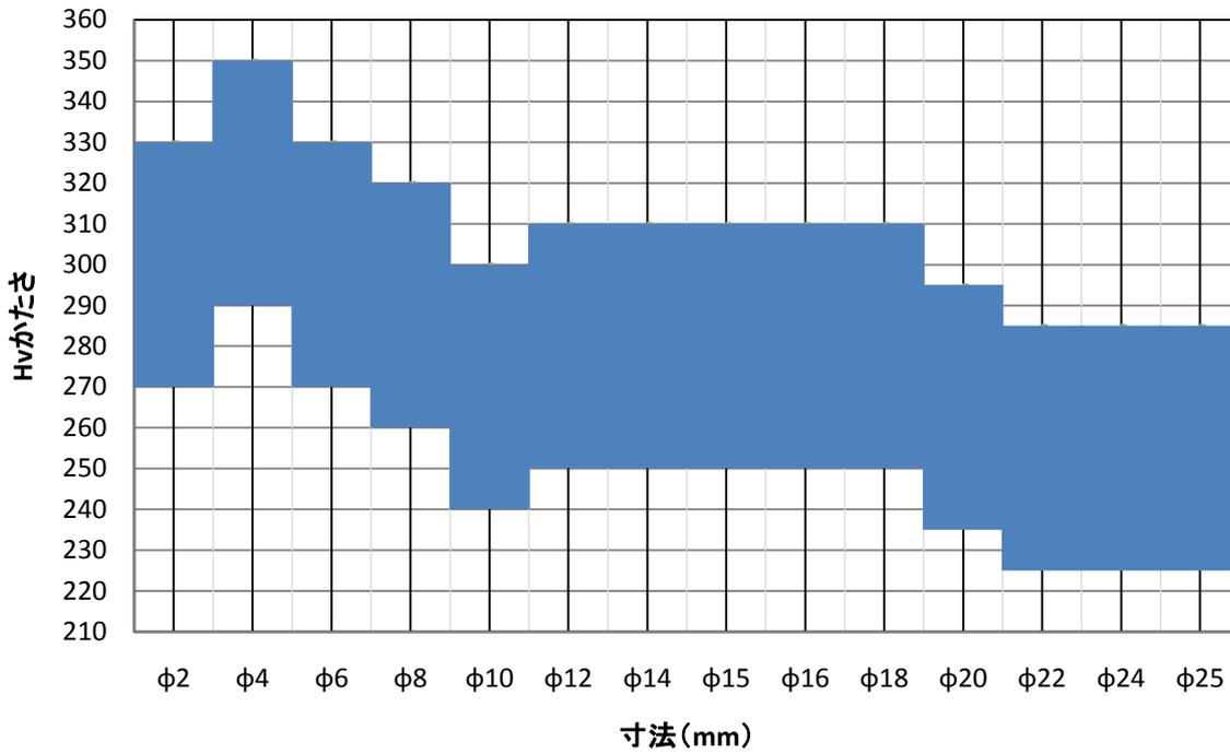
SUS303-D 寸法別機械的性質:Hvかたさ(測定位置:中心)
