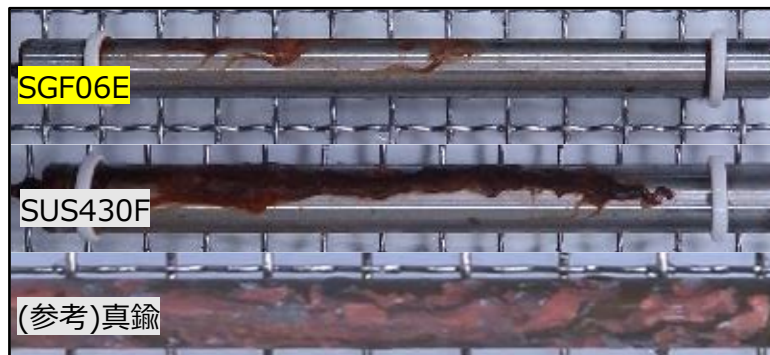
塩水噴霧試験(96hr)後のサンプル外観 (JIS Z 2371)
